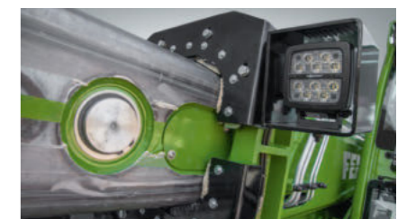
Schmutzabstreifer • Verhindert das Eintreten von Schmutz in das Innere des Teleskopauslegers und Beschädigungen
