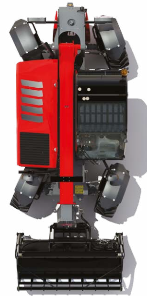
Allrad-Lenkung – für minimale Wendekreise.
