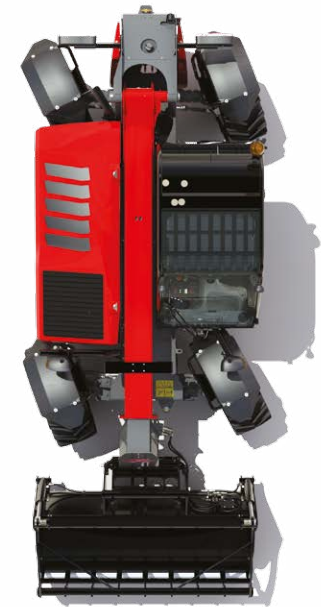
Hundeganglenkung – für effizientes Befüllen und Planieren und für Arbeiten an Mauern sowie in engen Räumen.
